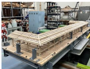
写真3.4 屋根面の剛性の違い (左:非剛床 右:剛床)
