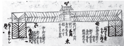
図 15 安政奈良地震での八幡社倒壊状況
