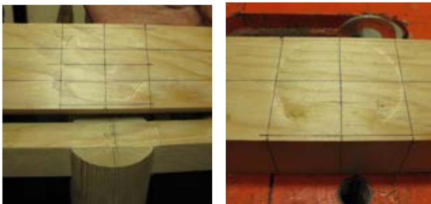
写真 8.1 実験でできためり込み痕 (左: 台輪 右: 土台)
