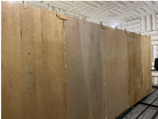
画像7 有孔板とベニヤ板の遮音壁 (音源側)
