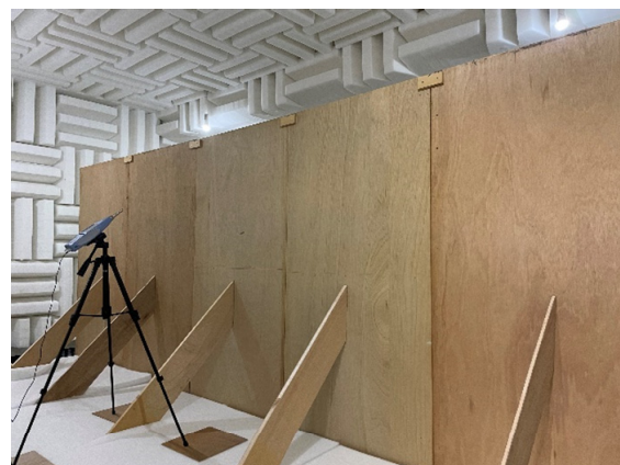
画像 4 ベニヤ板のみの遮音壁(受音側)
