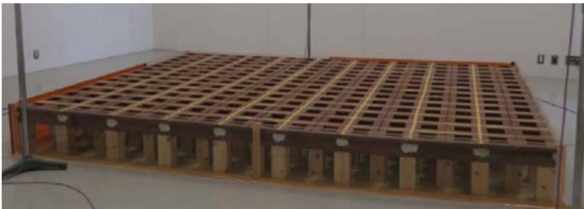
写真 1.3 コンクリートブロックの並べ方
