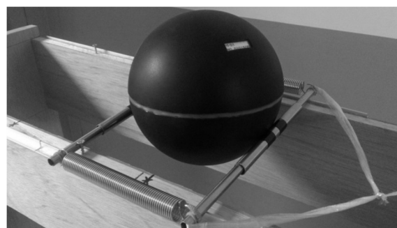
図 26 金属ローラーの落下装置
