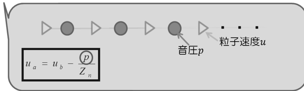
図 16 音圧と粒子速度の更新モデル
