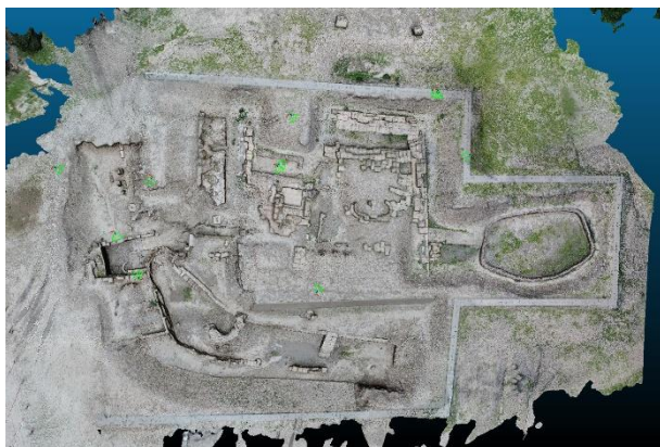
図-2 SfM による 3 次元データと 推定されたスキャン地点
